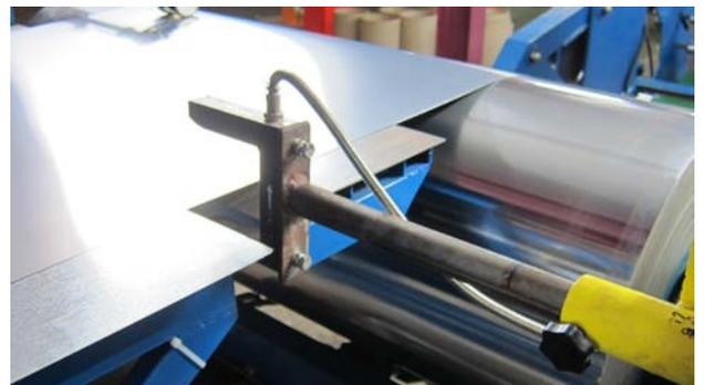
Sensor Infrarrojo DS-100 se utiliza en Máquina de acabado de la banda de acero.
